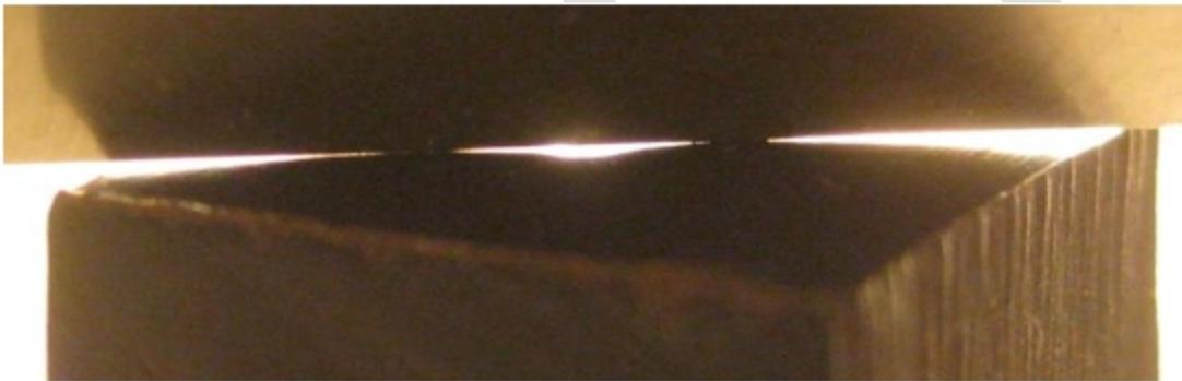
压痕——按照上面的A——可以很容易地发现, 然而, 根据第8.4 b)包括图2, 使用第5.4条款中规定的光学设备测量所需的直径时, 向上的形变不可见。
